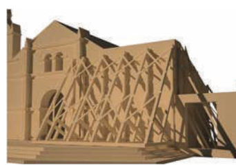
28 Maqueta digital del apuntalamiento provisional (parte anterior)
