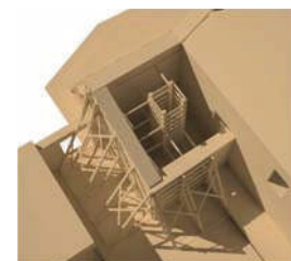
29 Maqueta digital del apuntalamiento provisional (parte lateral e interna)
