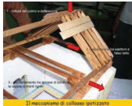
6 Maqueta de los mecanismos de colapso por el ciclón George (1998)
