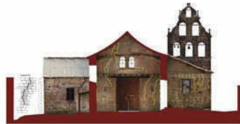
22 Conjunto de grietas en la fachada
